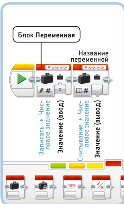
Рис. 16.4. Хранение и считывание значений с помощью блока **Переменная**
