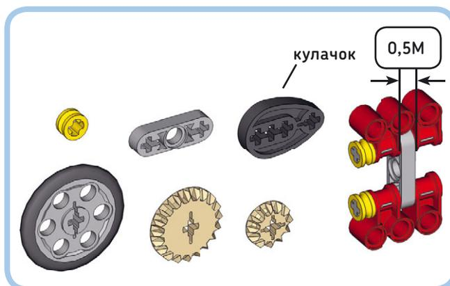
Рис. 10.22. Тонкие детали в наборе MINDSTORMS EV3
