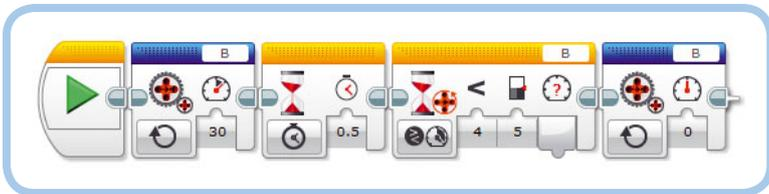
Рис. 9.8. Программа WaitForStall крутит мотор В, пока он не заглохнет. Обратите внимание, что первый блок **Ожидание** требуется, чтобы предоставить мотору некоторое время для набора скорости, в противном случае при измерении скорости значение частоты вращения будет равно нулю, в результате чего программа немедленно завершит работу
