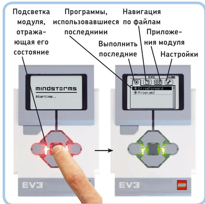
Рис. 2.7. Включение модуля EV3 с помощью центральной кнопки открывает меню с четырьмя вкладками. Вкладка **Выполнить последние** (Run Recent), находящаяся справа, содержит список программ, которые использовались последними
