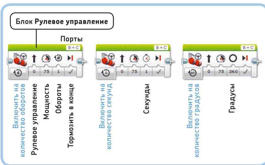
Рис. 4.6. Режимы (выделены синим цветом) и соответствующие параметры (выделены черным цветом) блока **Рулевое управление**. Чтобы выбрать другой режим, нажмите кнопку выбора режима и выберите подходящий пункт в раскрывающемся списке. Большинство параметров будут одинаковыми независимо от того, какой режим вы выбираете
