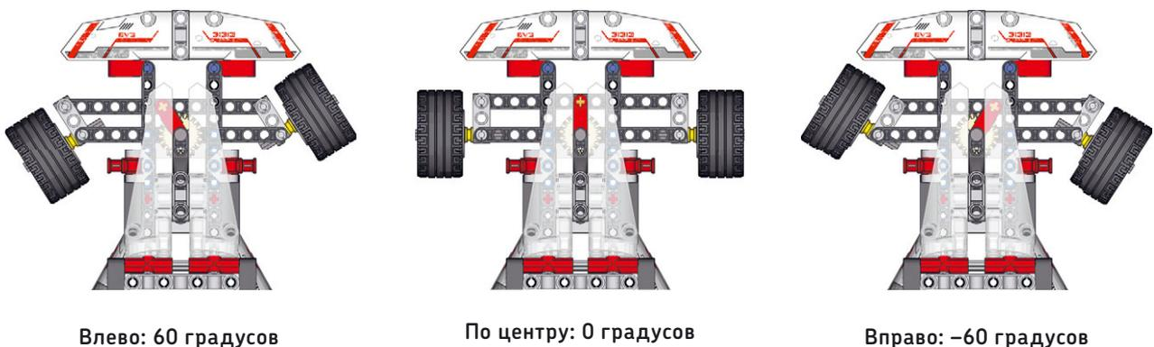
Рис. 12.3. Значения датчика вращения для различных положений передних колес. Убедитесь, что колеса находятся в центральном положении, прежде чем запускать приложение **Port View** для просмотра показателей датчика
