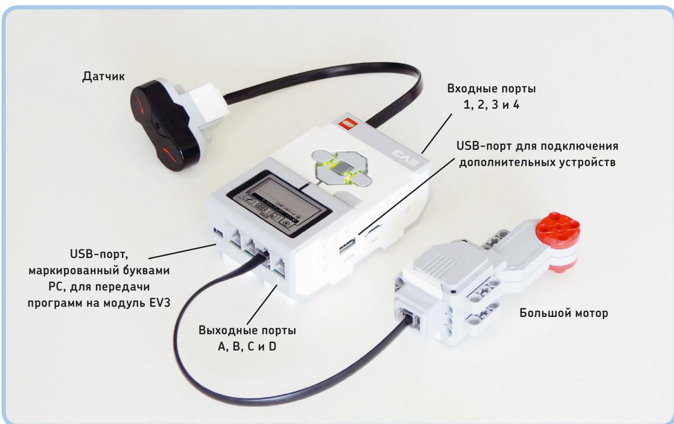
Рис. 2.5. Моторы подключаются к выходным портам, а датчики — к входным. Порт USB, который помечен буквами **PC**, используется для передачи инструкций с компьютера на модуль EV3
