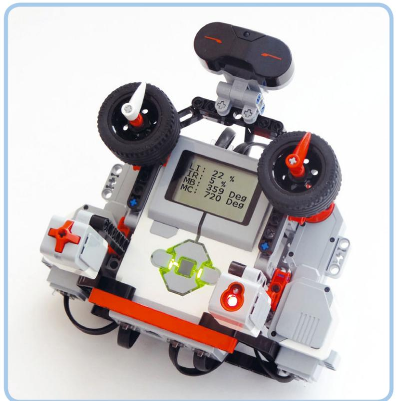
Рис. 14.1. Вы будете использовать СКЗТСНВОТ, для того чтобы изучить множество новых способов программирования, и для игры в «Волшебный экран» на экране модуля EV3
