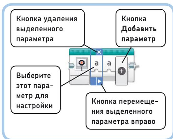
Рис. 15.17. Добавление, удаление и изменение порядка следования параметров
