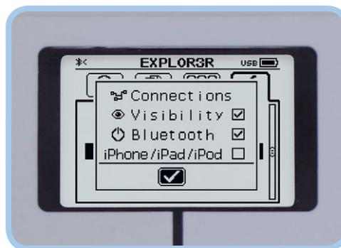
Рис. А.13. Перейдите на вкладку **Settings** на экране модуля EV3, выберите пункт **Bluetooth**, а затем установите флажки, как показано на рисунке. Флажок **iPhone/iPad/iPod** следует устанавливать только при дистанционном управлении с помощью устройств под управлением операционной системы iOS. Этот флажок следует сбросить, если Bluetooth-подключение используется для беспроводного соединения с компьютером или при дистанционном управлении с Android-устройства
