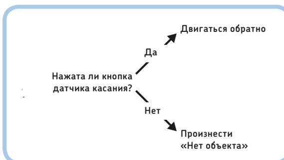
Рис. 6.11. Робот может действовать в зависимости от результата, измеренного датчиком
