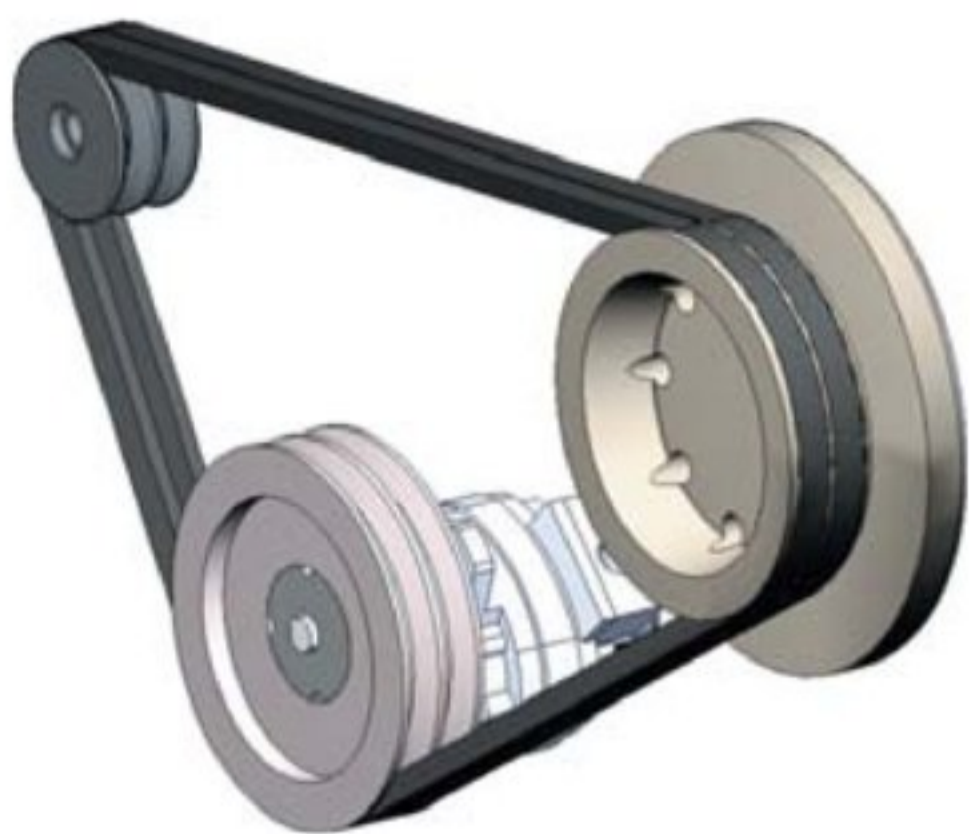
Рис. 1.39. Регулировка натяжения ремня
