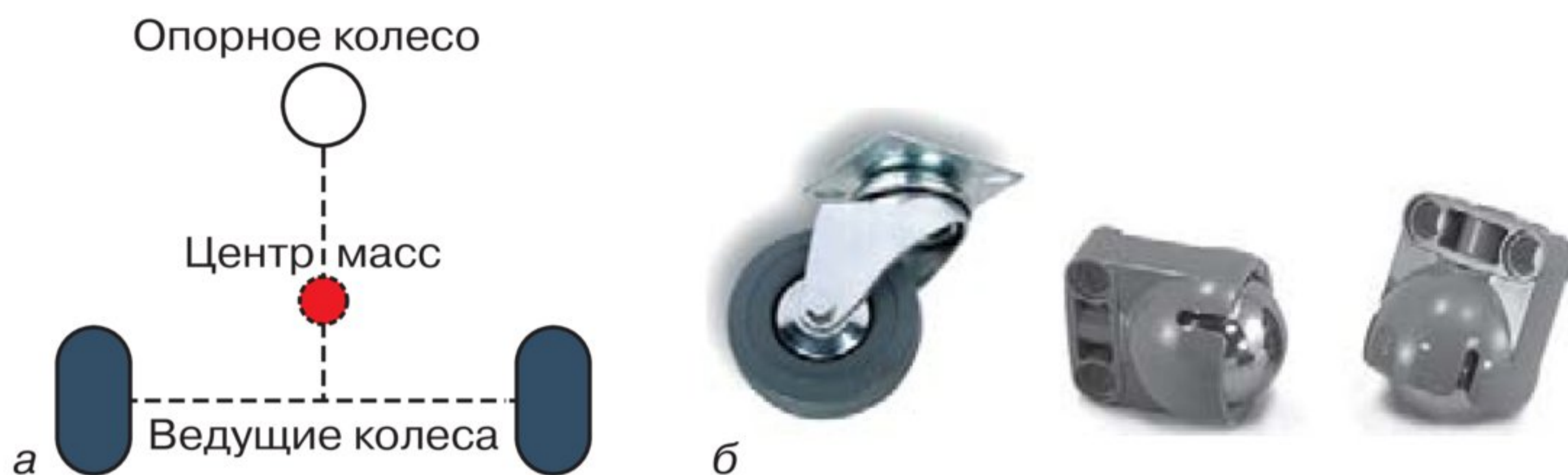
Рис. 3.14. Трёхколёсная схема (а) и виды опорных колёс (б)
