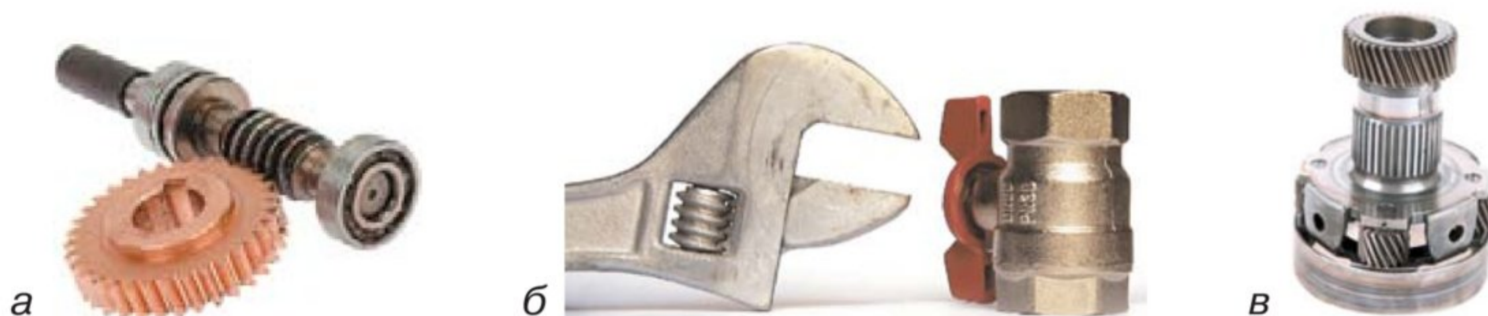
Рис. 1.32. а—в — примеры использования червяка в разных деталях и механизмах
