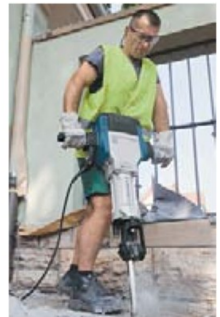
Рис. 4.5. Электрический отбойный молоток: внутри размещены двигатель и специальный кривошипно-шатунный механизм
