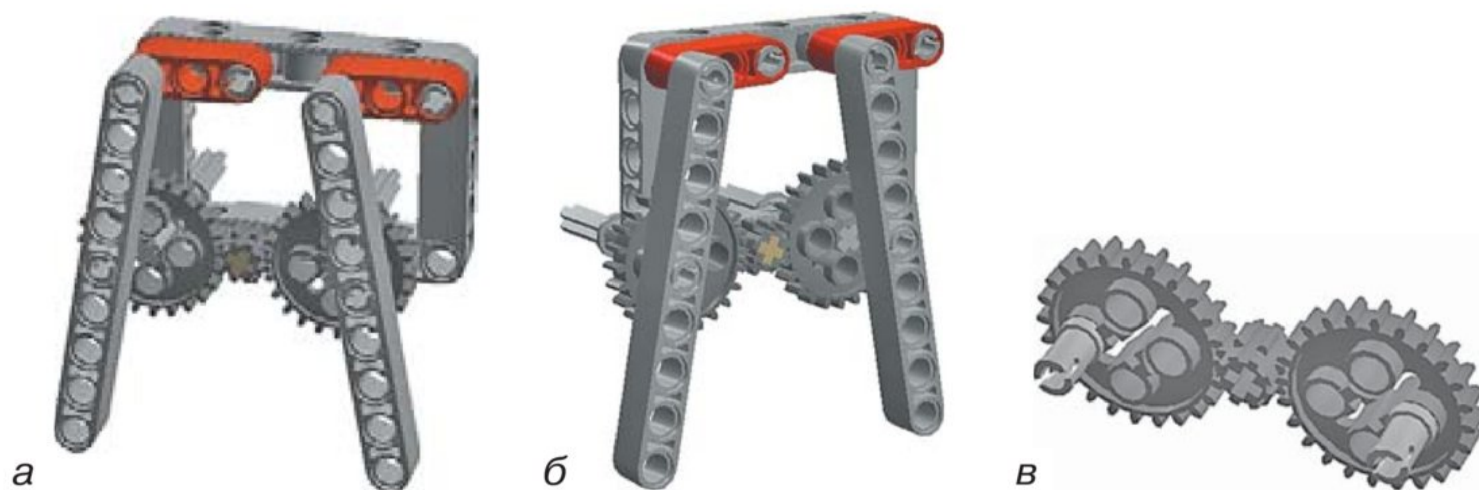
Рис. 4.17. Соседние ноги двигаются с разницей в 180^\circ за счёт разной установки кривошипов
