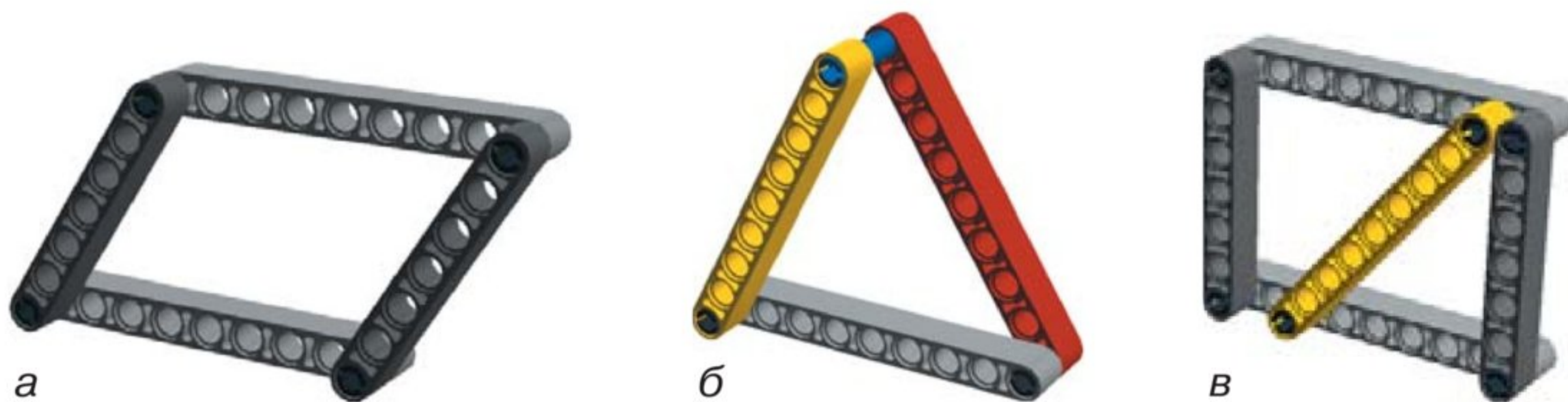
Рис. 1.21. а—в — придание жёсткости конструкции
