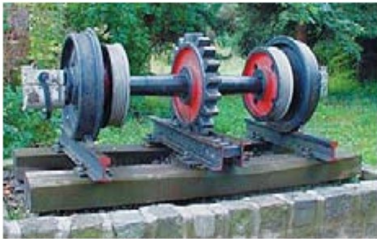
Рис. 1.25. Пример реечной передачи, использовавшейся на железной дороге Стефенсона
