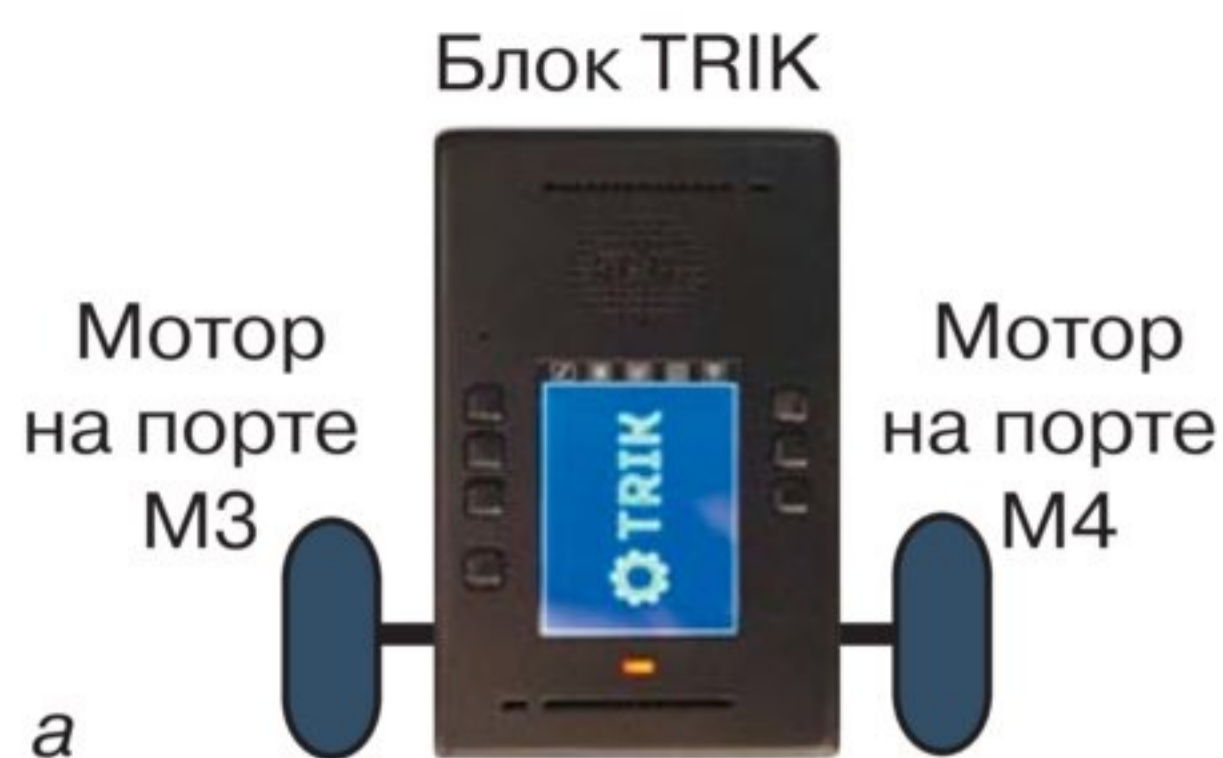
Рис. 3.15. Подключение моторов в двухмоторной тележке: а — на «ТРИК»; б — на EV3
