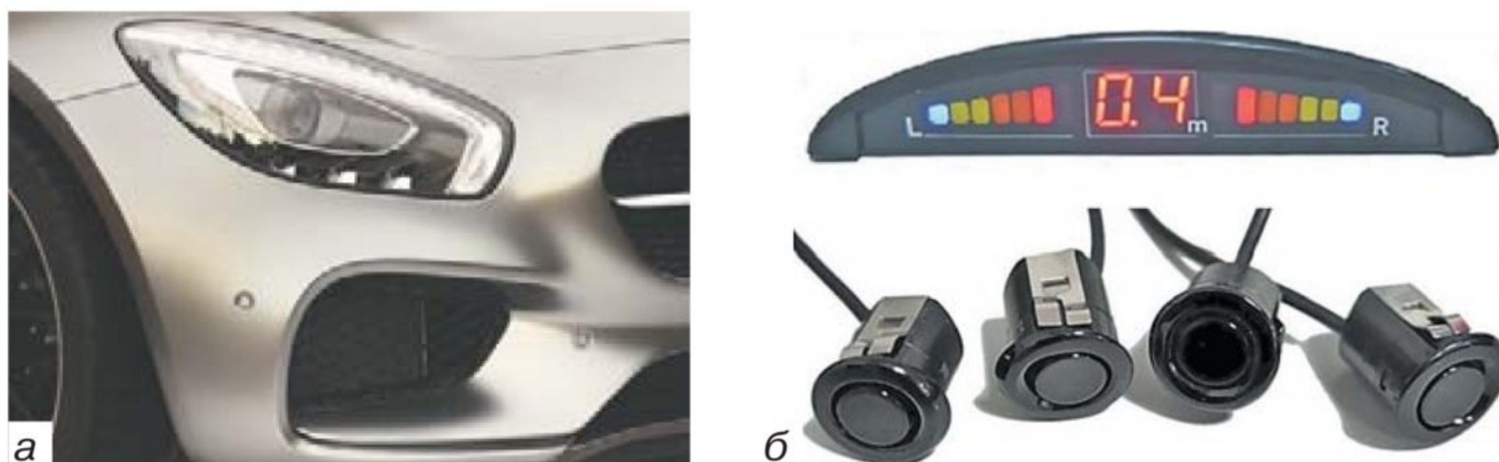
Рис. 5.66. Датчики расстояния (а) и сигналы системы (б)
