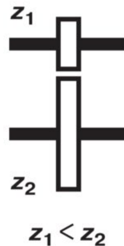
Рис. 1.28. Понижающая передача: а — рисунок; б — схема
