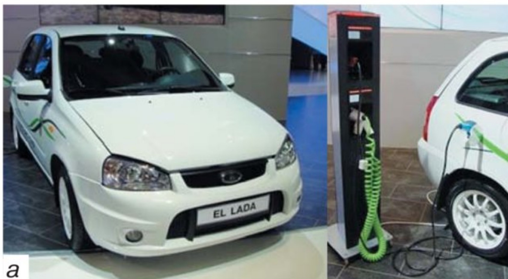
Рис. 2.9. Российский электромобиль El Lada (2014 год) со станцией зарядки (а) и электропогрузчик ЗиК (б)
