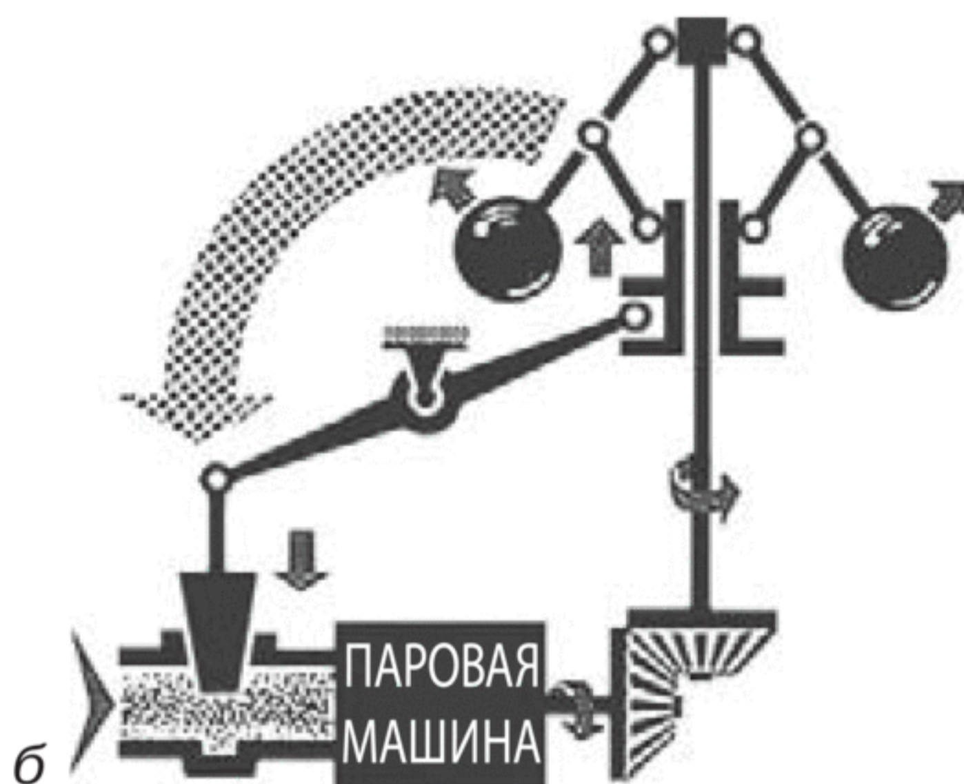
Рис. 5.31. Джеймс Уатт (а) и его центробежный регулятор (б)
