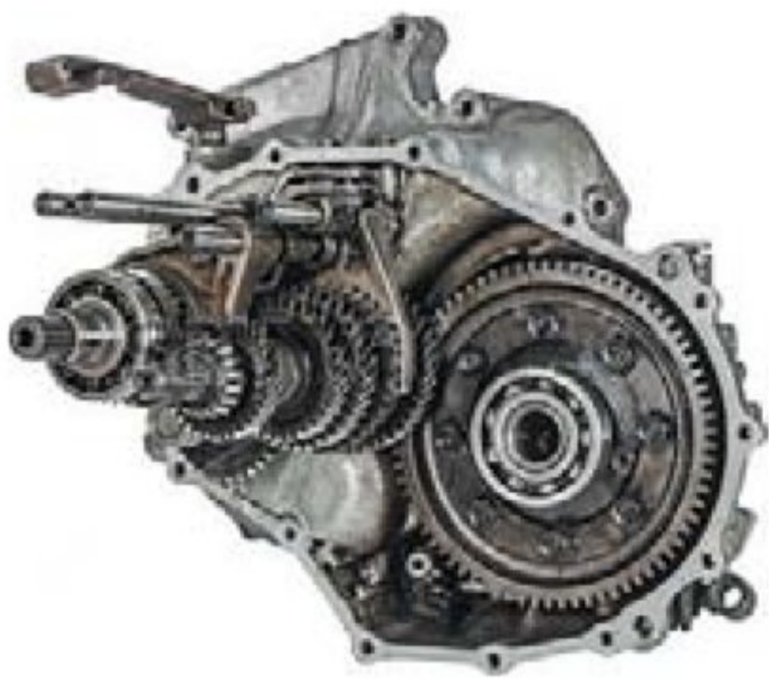
Рис. 2.19. Шестерни в коробке передач автомобиля
