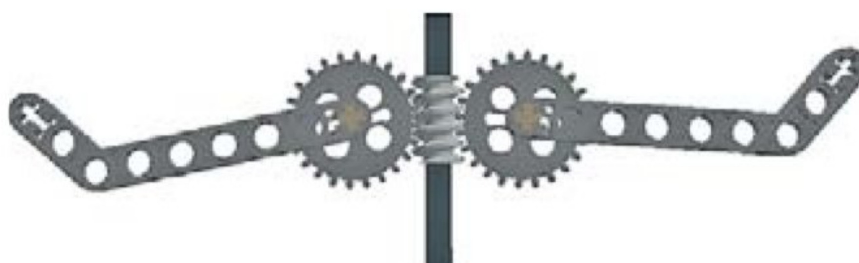
Рис. 5.87. Захваты на основе моторов EV3 (а) и на основе серводвигателя (б)
