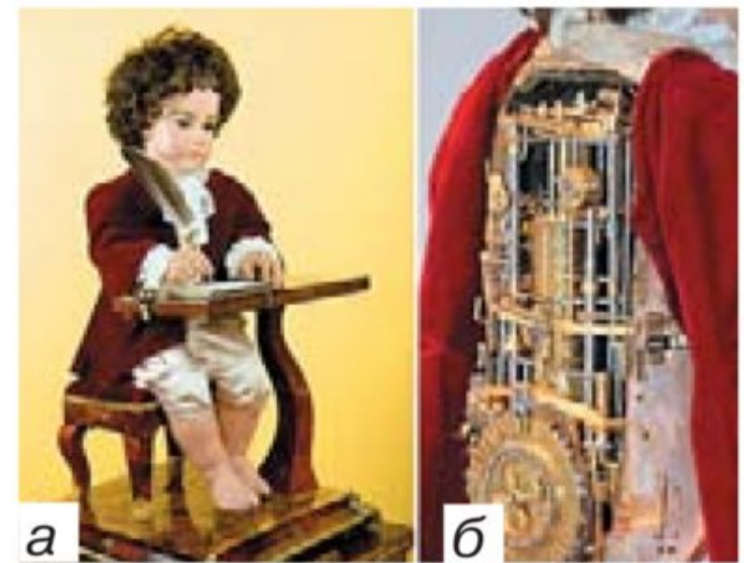
Рис. 1.5. Пишущая кукла: а — внешний вид; б — внутренний механизм
