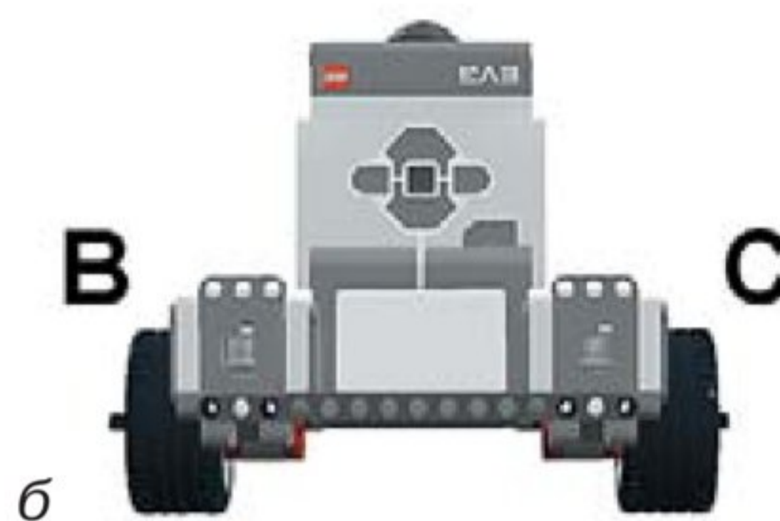
Рис. 3.15. Подключение моторов в двухмоторной тележке: а — на «ТРИК»; б — на EV3
