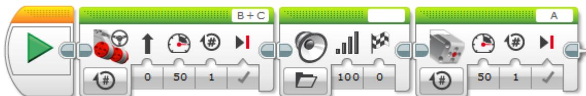
Пример записи линейного алгоритма на языке программирования EV3.
