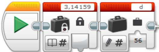
3. Используя программный блок «Математика», умножим значение блока «Константа» на значение переменной d. Для передачи значения из переменной d в программный блок «Математика» используем второй программный блок «Переменная» в режиме «Считывание». Для передачи значений между программными блоками используются шины данных. Чтобы установить шину данных, необходимо «потянуть» выходной параметр одного программного блока и «присоединить» его к входному параметру другого программного блока.
