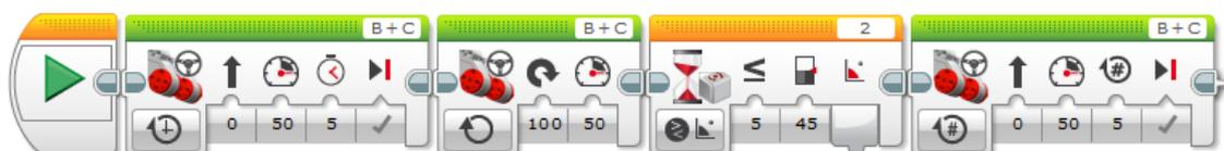
**Задача:** создать программу, чтобы робот проехал по траектории в виде квадрата.
