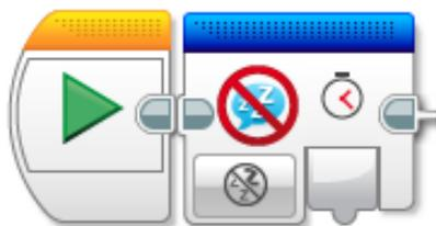
При каждом обращении к данному программному блоку происходит сброс значения таймера выключения робота на определённое число минут, продлевая время работы без выключения.
