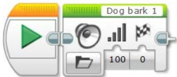
Звуки можно выбирать из стандартной библиотеки звуков. Если в блоке «Звук» установлен флажок «Ожидать завершения», то звуковой файл будет воспроизведен полностью, и только потом осуществлён переход к следующей команде.
